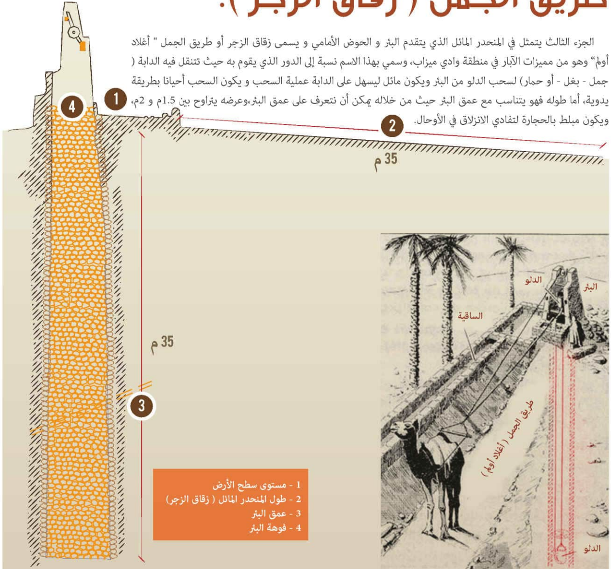
مقطع طولي تناسب عمق البئر مع المنحدر المائل ( زقاق الزجر )
