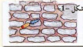
شكل 1- تنظيف الوصلات JOINTS
