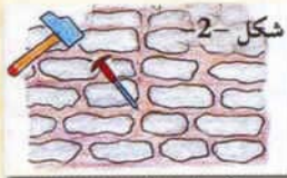
شكل 2- تنظيف الوصلات JOINTS
